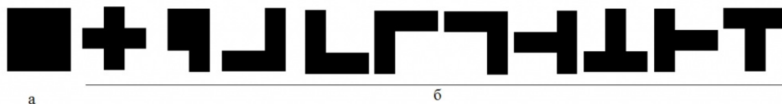
Цифровой формат с видом матрицы 6x6 (а) с наименьшей величиной промежутков между точечными элементами и цифровые знаки на его основе (б) с удвоенной толщиной контура их
