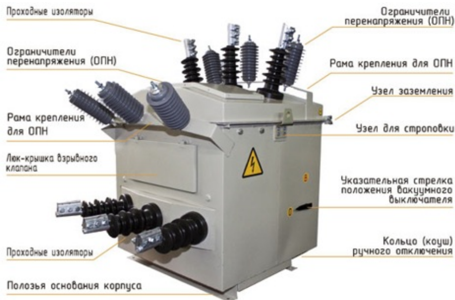
Рисунок 1 (а, б) — Устройство реклоузера.
