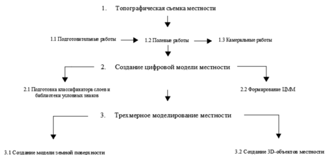
Рисунок 1- Технологическая схема создания трехмерной модели местности по топографическому плану
